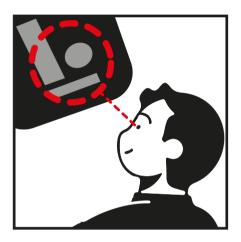
Prüfen Sie den Treiber, die LED-Platine und die Klemmleiste auf Anzeichen von Rost oder Oxidation. Das Vorhandensein dieser Anzeichen weist auf ein mögliches Eindringen von Wasser in die Leuchte hin.
