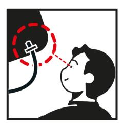
Dichtheit und Unversehrtheit aller Kabelverschraubungen und Stromkabel prüfen.
