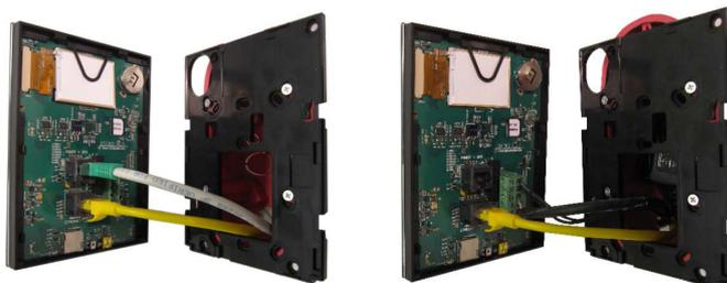
Le panneau avant est monté en le pressant contre la plaque arrière puis en le faisant glisser vers le bas.
