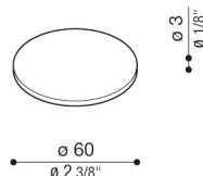
Cover decorativa in Policarbonato, disponibile in diverse colorazioni ed effetti, ricavato da stampaggio ad iniezione. Finitura effetto materico Corten, ottenuta tramite verniciatura. Applicazione della cover senza utensili tramite speciale striscia adesiva.
