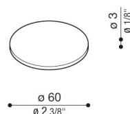
Cover décorative réalisée en polycarbonate et disponible en différents teintes et effets, fabriqué par moulage à injection. Finition effet matière Corten obtenue par vernissage. Application de la cover sans outil à l'aide de bande adhésive spéciale.
