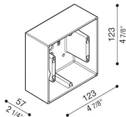
Box pour le montage au mur en saillie (pas à encastrement).
