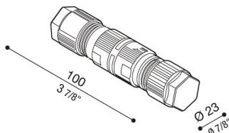
Bloque de terminales coaxiales de 4 polos, IP68, para cable con  $\varnothing$  7/13,5 mm.
