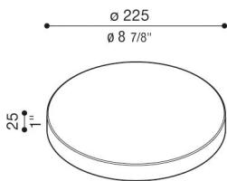
Accessorio CUT-OFF in alluminio; elevata resistenza all'ossidazione grazie al trattamento di passivazione a base di zirconio e alla verniciatura con resine poliestere stabilizzata ai raggi UV. Obbligatoria l'installazione sul modello LINE 220, non compreso.
